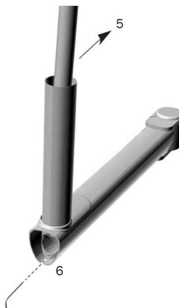
Figure 85. Installation du support d'écran côté support
